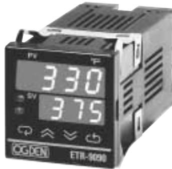
VISUALIZACIÓN DESPUÉS DEL CAMBIO EN REGISTRO. AJUSTE EL SV A 330.
