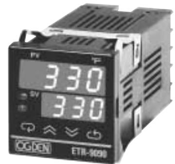
VISUALIZACIÓN DESPUÉS DEL CAMBIO Y DEL AJUSTE DEL SV.
